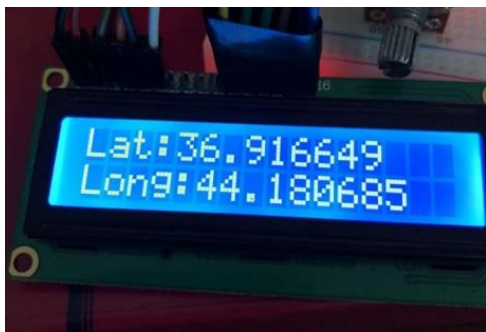
Fig. 8: Picture of vehicle location Latitude and Longitude on LCD
